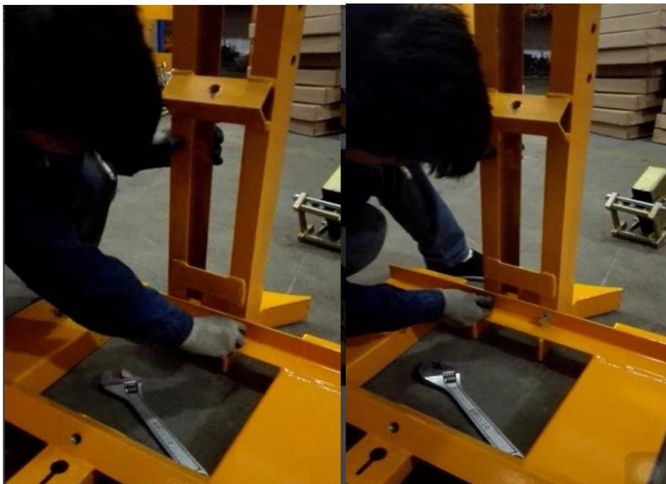
2. Закрепите соединительную штангу (6) на раме, используйте детали 12, 13, 14:
